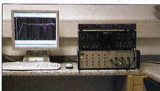
Il sistema di misurazione (circa 30.000 euro) verifica le prestazioni degli ampli
