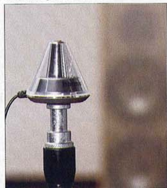
Con l'ausilio del microfono, l'amplificatore Harman/Kardon misura la resa sonora dei propri diffusori
